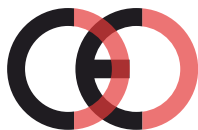
Falsche CE-Kennzeichnung (zu dicht)
