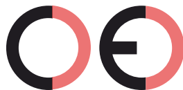
Falsche CE-Kennzeichnung (zu großer Zwischenraum)
